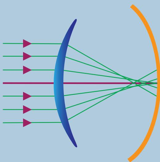
Con un diseño tradicional esférico, los rayos de luz convergen en un "círculo de confusión"
